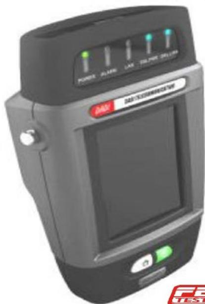
Instrumento Avanzado para prueba en ADSL1/2/2+: Realiza verificación y localización de problemas en circuitos ADSL1/2/2+ y bucles de cobre.
