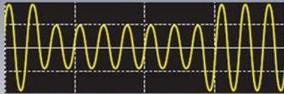
HUNDIMIENTOS DE VOLTAJE (DIP)
